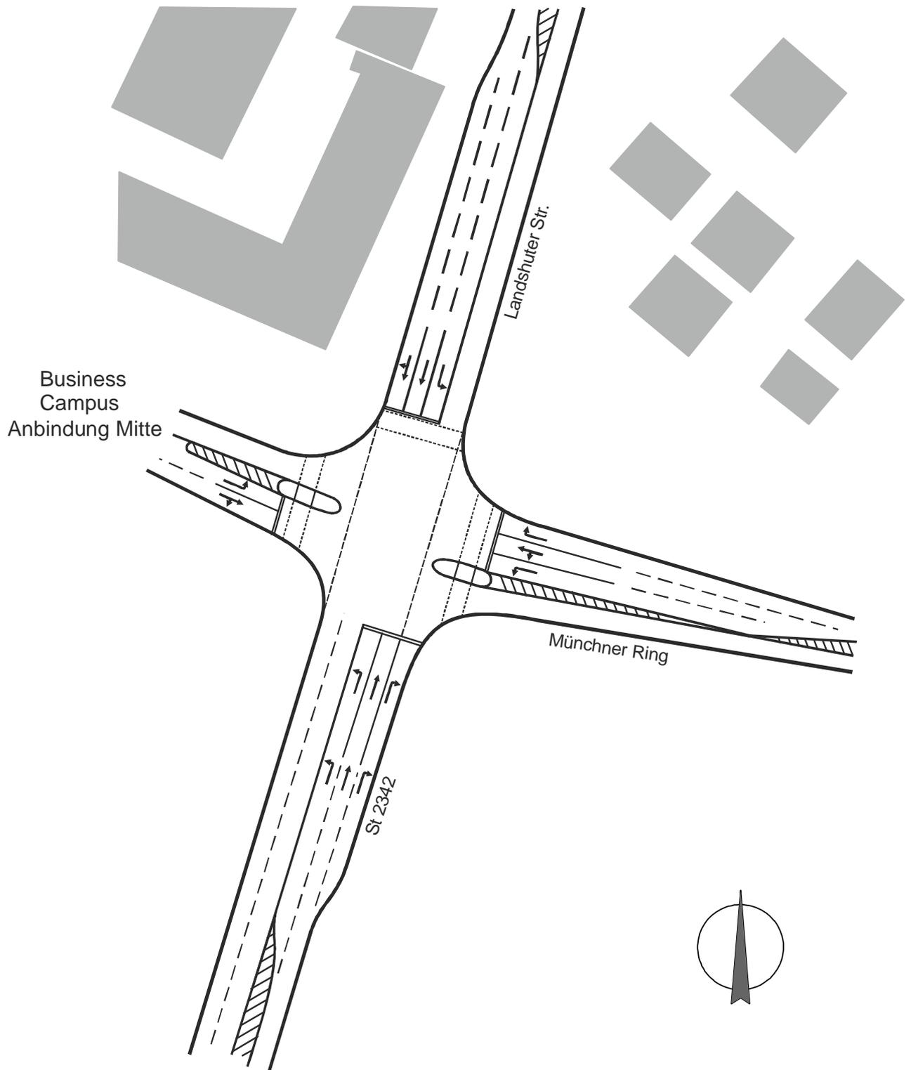
Abb. 3a: Skizze Ausbauvorschlag St 2342 / Münchner Ring / Anbindung Mitte
