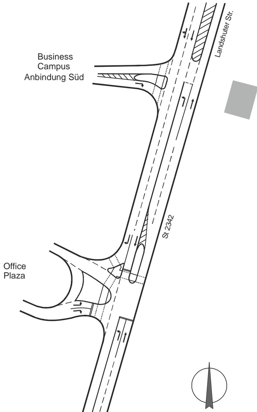
Abb. 3b: Skizze Ausbauvorschlag St 2342 / Anbindung Süd und Anbindung Office Plaza
